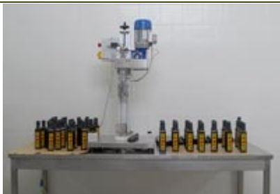
Un momento della fase di imbottigliamento, in particolare della macchina tappatrice ed avvitatrice.
