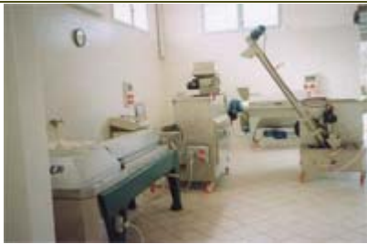
I macchinari: in fondo si può intravedere il denocciolatore, in primo piano sulla destra la "lavatrice", a sinistra in fondo il "quadro dei comandi", al centro la gramola composta da due macine e in primo piano a sinistra il decanter.
