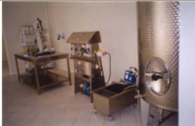
La stanza dell'imbottigliamento: in primo piano a destra un silos di acciaio, la macchina riempitrice a depressione e la tappatrice.
